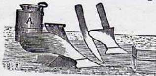
17. Pflügekörper D8SS mit zugehörigem Soch und Vorschneider, sowie mit Wasserleitung A. Tiefgang 10-21 cm = 4-8 Zoll rhl. Marke D9SSN mit höherem Stahlgußkörper. - Marke R14SS, D9SS (Abb. 9), starke Pflüge für sehr schweren Boden, mit stark gewundenem Strichblech.
