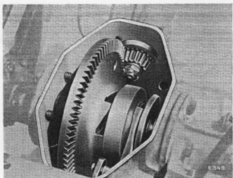
Kettenloser Kegelradantrieb im staubdicht gekapselten Ölbad.
